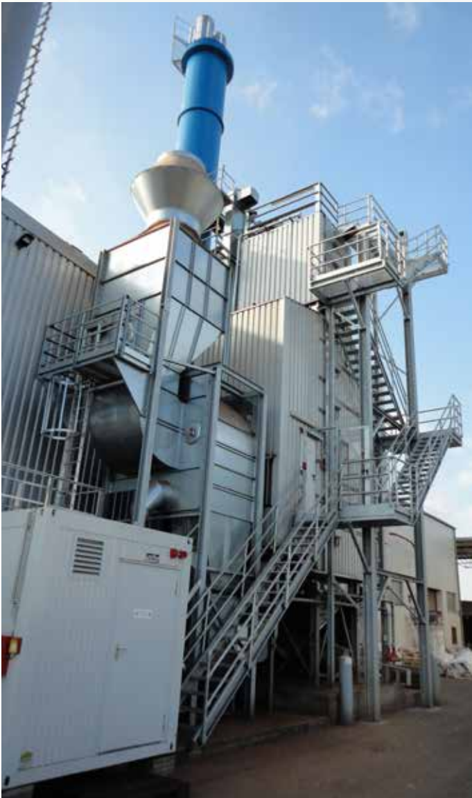
Projekt: Commodity Euromar Deutschland, Fehrbellin Typ: GDB-TN 1/5-S Baujahr: 2010 Produkt: Kakaobohnen Trocknerleistung: ca. 5,0 t/h von 15% bis 2%
