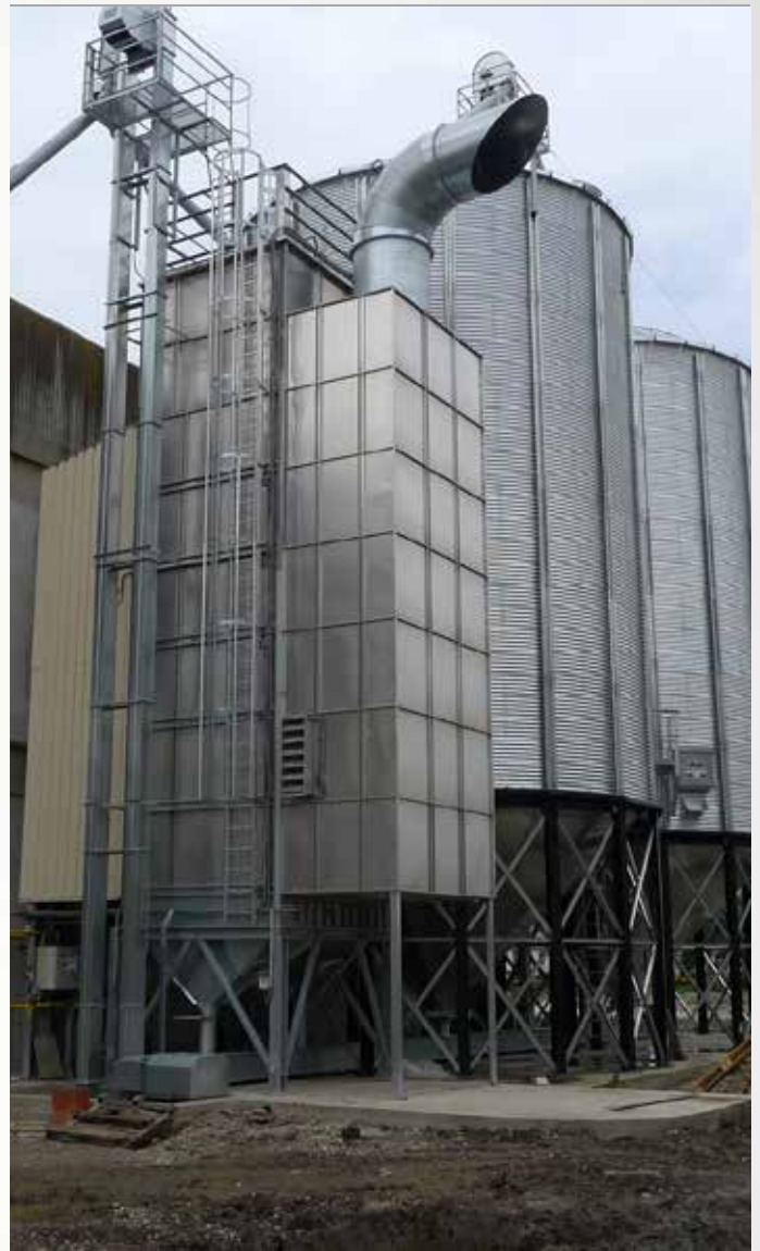
Projekt: Ostrov Tschechische Republik Typ: GDB-XN 1/6-S Baujahr: 2009 Produkt: Mais, Weizen Trocknerleistung: Weizen: ca. 28,9 t/h von 19% auf 15% Mais: ca. 7,2 t/h von 35% auf 15%
