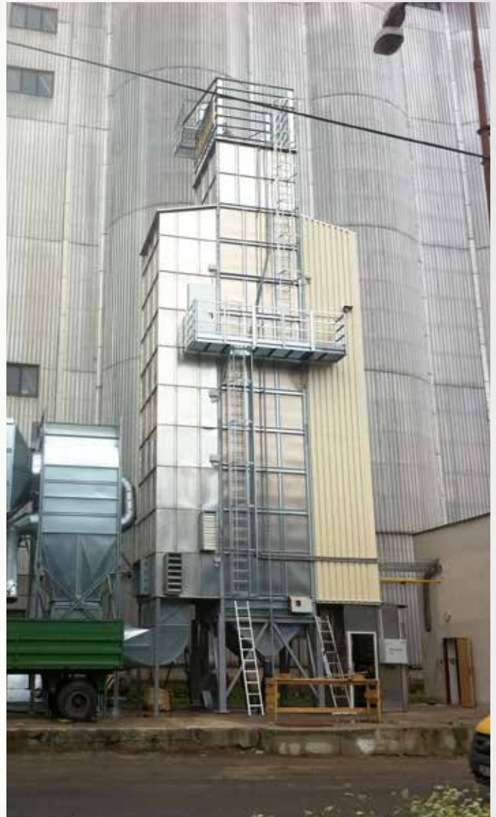
Projekt: Agrofert - Sedlcany Tschechische Republik Typ: GDB-XN 1/10-S Baujahr: 2011 Produkt: Raps Trocknerleistung: ca. 27,5 t/h von 12% auf 8%
